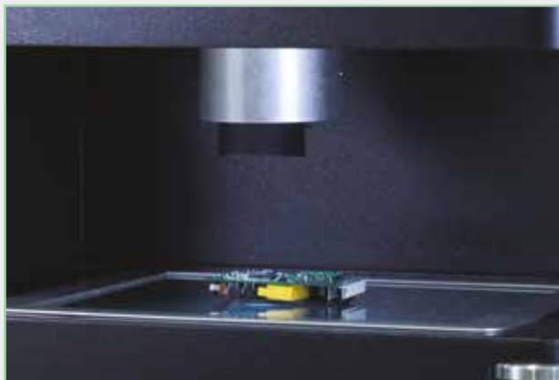
Campo di misura 400 x 300 mm Measuring range 400 x 300 mm
